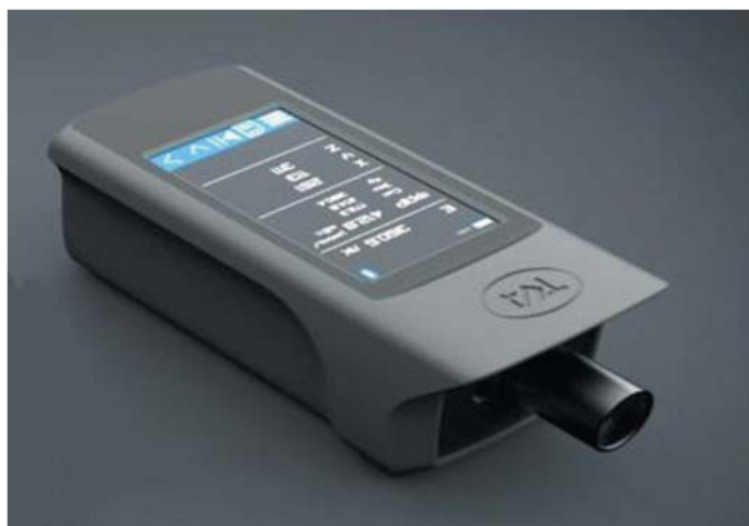
Рис. 2. ТКА-Спектр Спектрорадиометр Fig. 2. TKA-Spectrum Spectroradiometer
