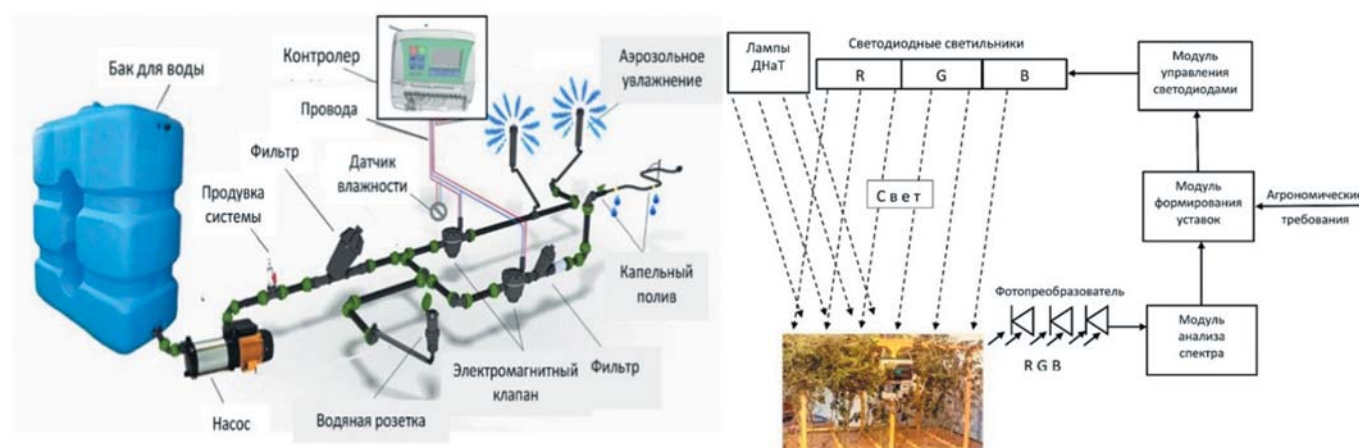
Рис. 6. Схема системы управления орошением технологического модуля с управляющим спектром облучения при производстве миниклубней картофеля Fig. 6. Scheme of the irrigation control system of the technological module with the control spectrum of irradiation in the production of potato minitubers
