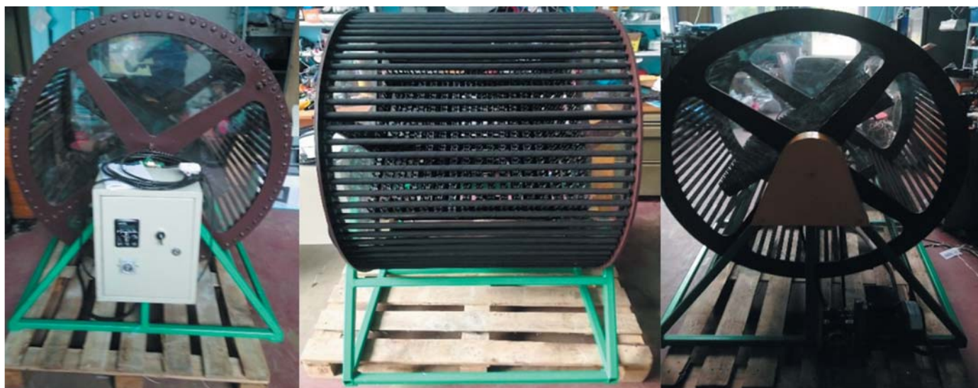
Рис. 2. Общий вид макетного образца устройства для оценки пригодности сортов и гибридов к механизированной уборке Fig. 2. General view of a prototype device for assessing the suitability of varieties and hybrids for mechanized harvesting
