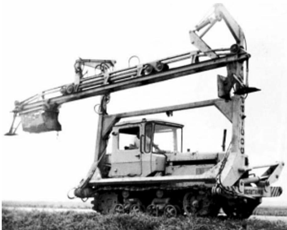
**Рис. 1. Каналоочиститель с ковшом на жестких направляющих**
