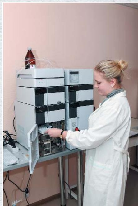
**Определение витаминов группы В на приборе ВЭЖХ Schimadzu (Япония)**
