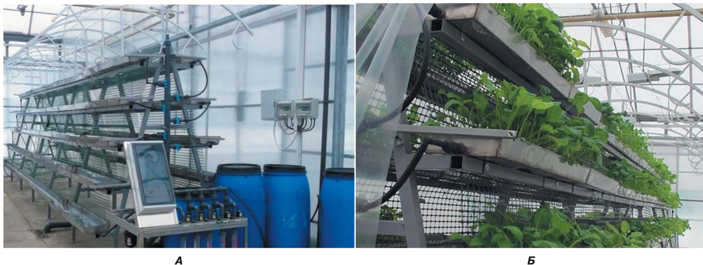
Рис. 1. А - внешний вид установка МУГ с узлом автоматизированной подачи раствора;
