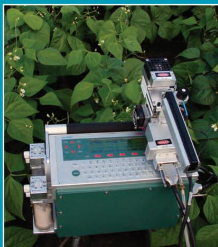
Рис. 2. Портативный газоанализатор Li-6400 XT (фирма Li-COR, США) для изучения интенсивности фотосинтеза и транспирации.
