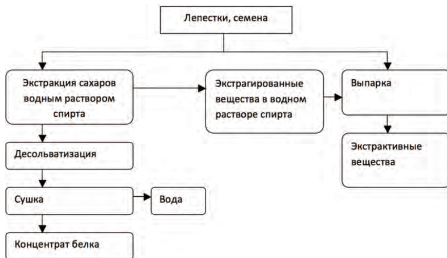
Рис. 2. Схема производства концентратов методом спиртовой экстракции.
