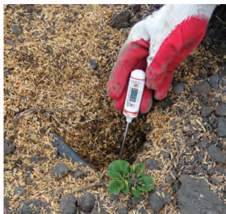
Рис. 2. Измерение температуры почвы под мульчирующим материалом (рисовая шелуха) при весеннем сроке посадки.
