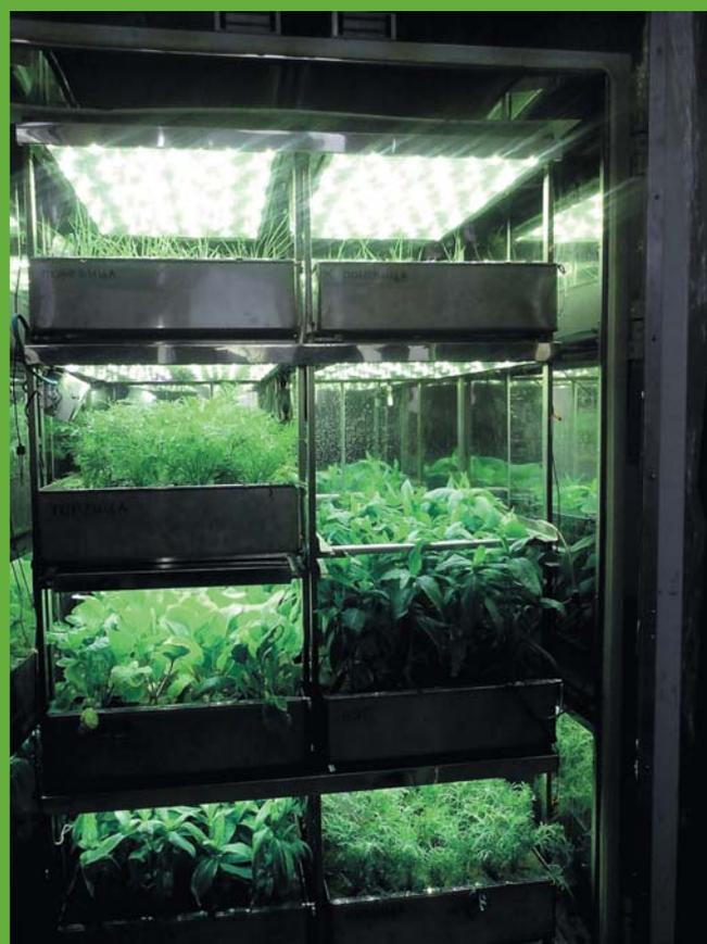
**Рис. 8. В синерготроне модели ИСП-2.01. реализована возможность изменения высоты зоны выращивания растений. В правой части снимка – для обеспечения пространства для дальнейшего роста нуга абиссинского один из лотков удален. На верхнем ярусе – растения полевицы ВИК-2, на двух средних левых – горчица салатная Мустанг (2019)**
