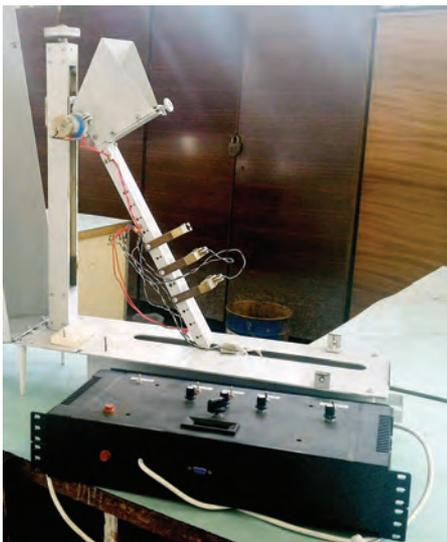
Рис. 1. Установка для оптической обработки семян овощей "Луч-2".
